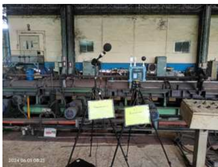
ภาพที่ 3.13.2 ภาพแสดงการตรวจวัดระดับเสียงภายในพื้นที่ทำงาน
