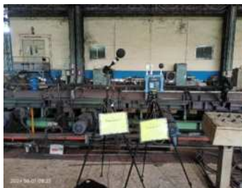
ภาพที่ 2.10 ตรวจวัดความร้อนและเสียงในพื้นที่ทำงาน
