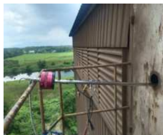
ภาพที่ 3.5.1 ภาพแสดงการเก็บตัวอย่างคุณภาพอากาศจากปล่องระบายอากาศ
