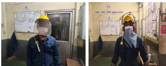
ภาพที่ 2.22 ตรวจสอบวัดฝุ่นที่ตัวพนักงาน
