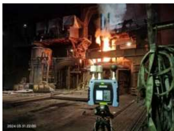
ภาพที่ 2.10 ตรวจวัดความร้อนและเสียงในพื้นที่ทำงาน
